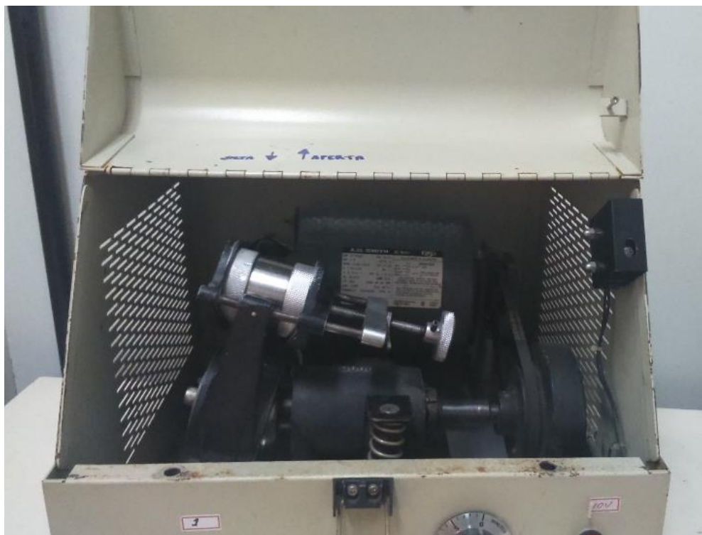
Figura 11. Moinho SPEX com cadinho acoplado. O motor movimenta o braço do moinho produzindo vibração do cadinho.
