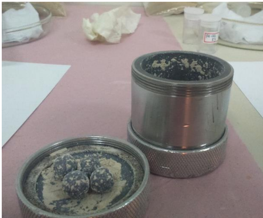
Figura 12. Cadinho e bolas de carbetto de tungstênio utilizados na pulverização do material particulado.
