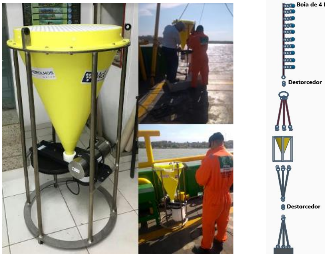
Figura 7. (Esquerda) Manutenção do sistema automático de coleta de sedimento (McLane) e sua instalação no Parque Nacional dos Abrolhos; (Direita) Disposição do amostrador a partir do fundo marinho.
