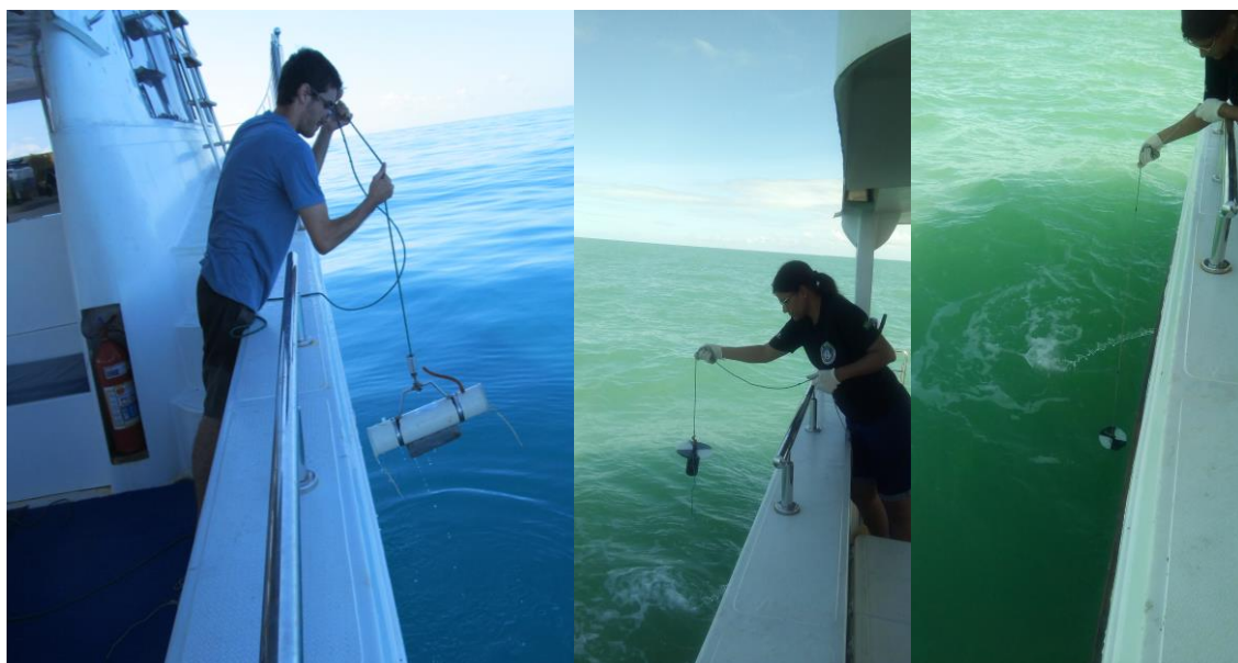
Figura 1. Procedimento de coleta de água superficial com Garrafa de Van Dorn e observação da profundidade de atenuação de luz utilizando Disco de Secchi, a aferição do pH e temperatura da água.
