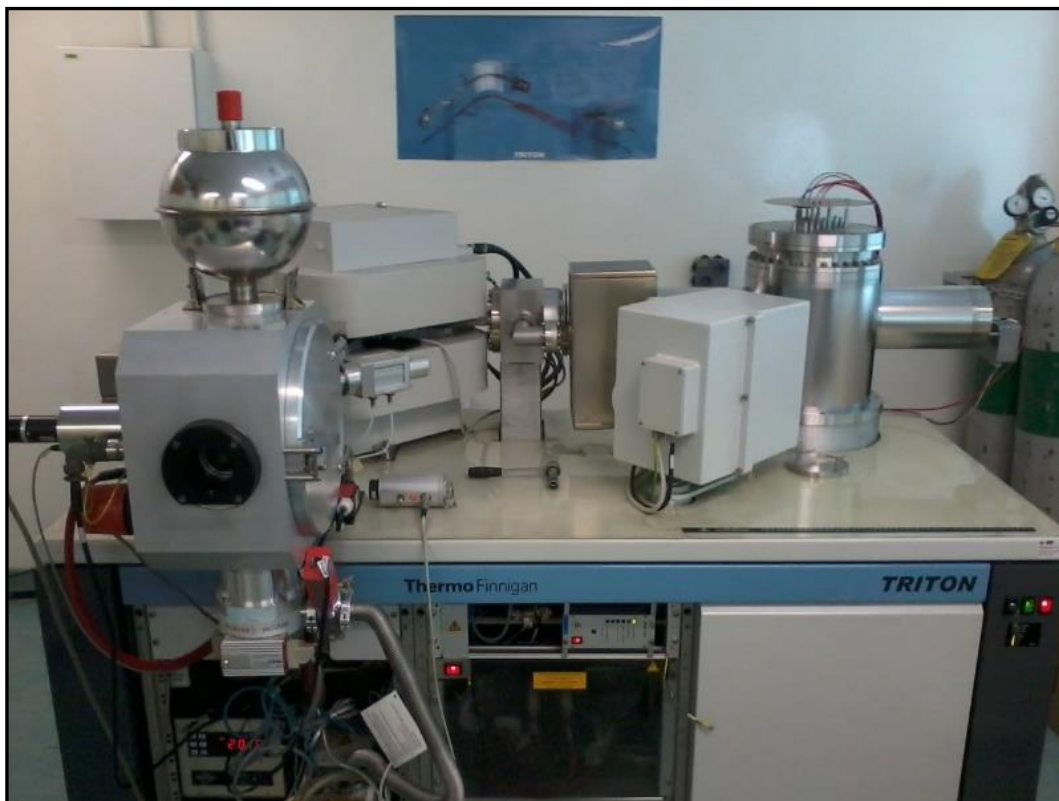
Figura 16. Espectrômetro de massa portermo-ionização (TIMS) multicoletor, modelo TRITON da Thermo Scientific.
